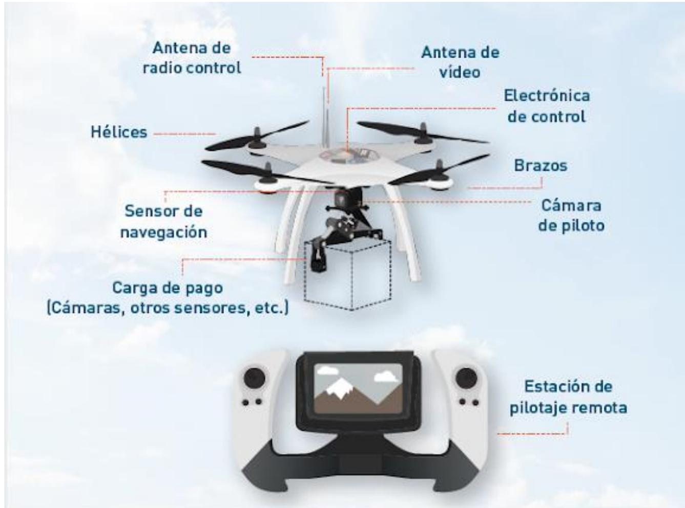
Figura 3: Elementos básicos de un dron multirrotor.
