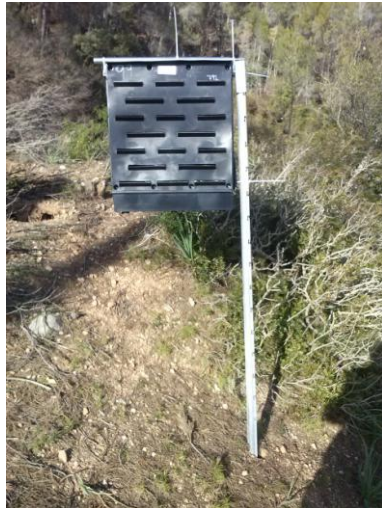
Foto 2: Trampa tipo Theyson© en el perímetro de la zona incendiada para la captura de escolítidos
