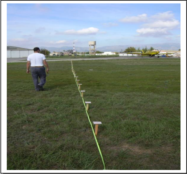
20.5 Col·locació cada 2 m de controls
