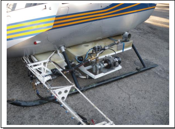
15.13 Depòsit ventral i bomba impulsora
