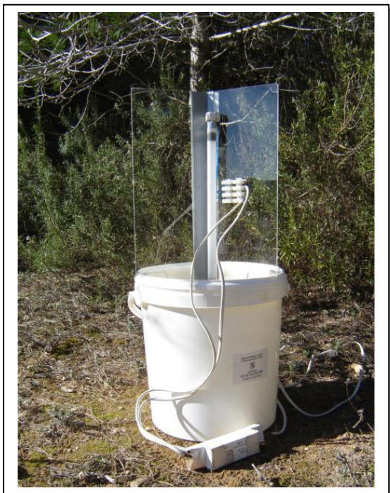
13.3. Trampas de luz negra para procesionaria Ibiza-Formentera
