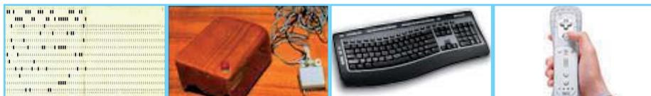
Figura 2: Ejemplos de interfaces utilizadas para interactuar con el ordenador: (a) tarjeta perforada, (b) primer ratón, (c) teclado de Microsoft, (d) Mando de la Nintendo Wii.
