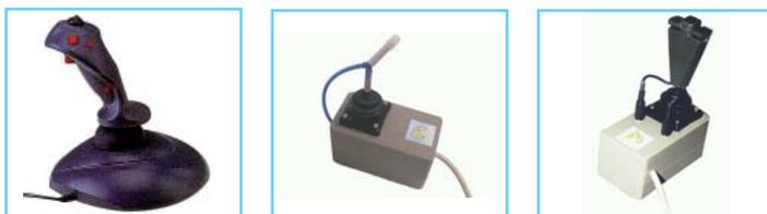
Figura 8: Joysticks de mano, de boca y de mentón. (Fuente: Catálogo de ayudas técnicas del CEAPAT)
