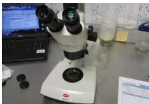
**Fotografía 2:** Tamiz y estereomicroscopio utilizado en la separación e identificación de los invertebrados.
