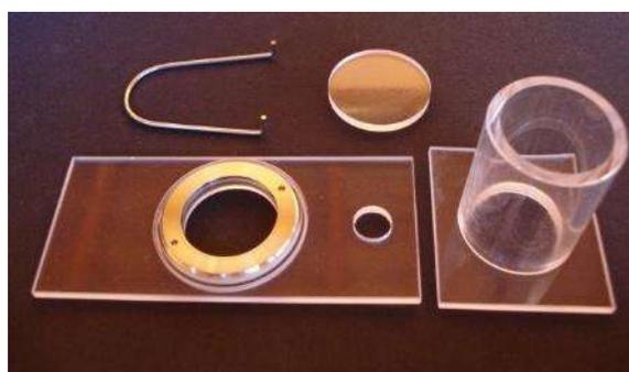
**Fotografía 3:** Cámara y columna de sedimentación.
