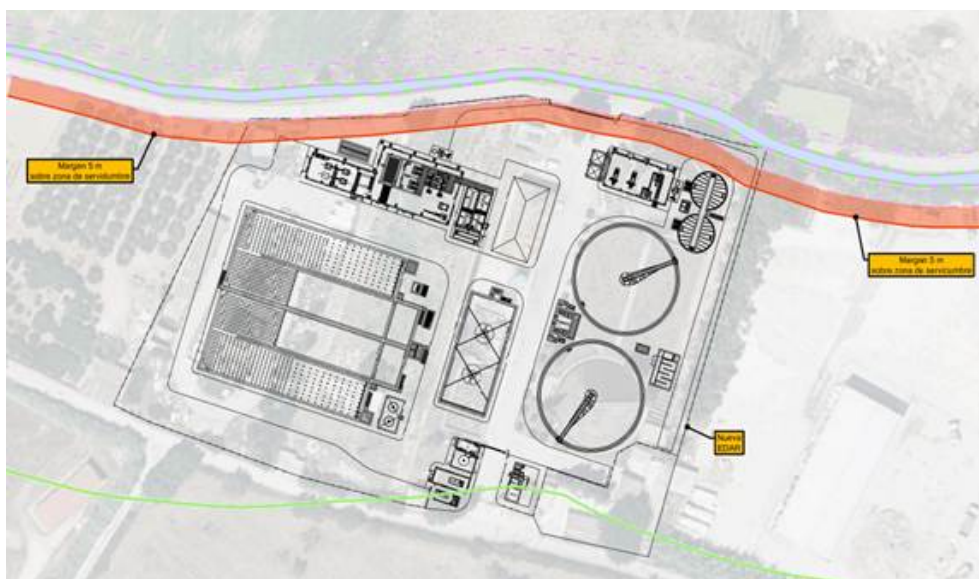
Figura 10. Zona de servidumbre del torrente de Inca. Ningún elemento de la EDAR se emplaza dentro de esta zona, a excepciones de los muros perimetrales.
