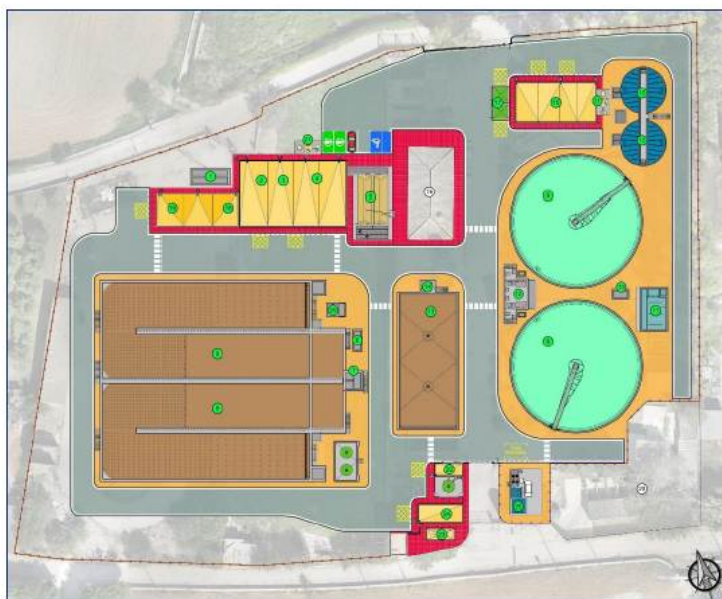
Figura 3. Disposición de los elementos de la nueva EDAR reformada y ampliada. Fuente: Proyecto reformado de ampliación.
