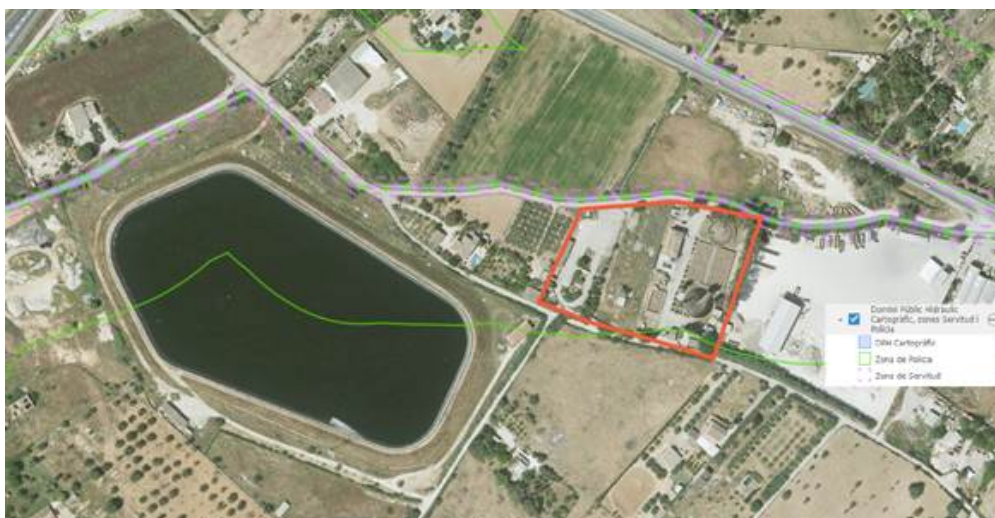
Figura 9. La línea verde marca la zona de policía del torrente. Como se puede observar, la práctica totalidad de la zona de actuación se encuentran dentro de esta franja de 100 metros.
