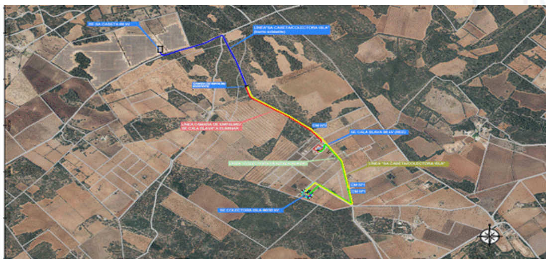
Fig.5: Líneas de evacuación desde S/E Isla. Fuente : Proyecto
