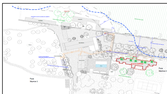
Fig. 2.- Plano de ubicación del nuevo volumen, demolición parcial (105,84 m 2 ) del edificio «porqueres 1», previsión placas solares sobre cubierta edificio «porqueres 2», previsión ubicación aproximada de la nueva fosa séptica 1, previsión ubicación aproximada de la nueva fosa séptica 2, ubicación previsión aparcamientos. Fuente: Documento ambiental.
