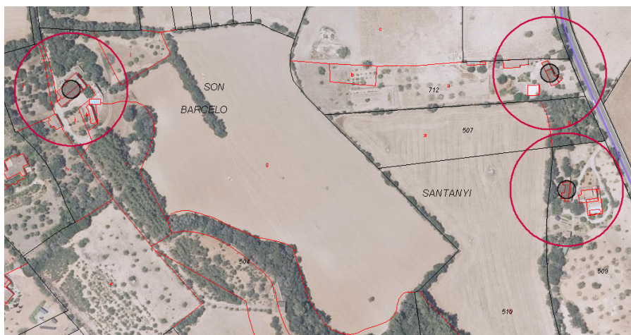
Figura 5. Viviendas aisladas alrededor del PFV proyectado. Se marca con un círculo rojo el radio de 50 metros. Las placas e instalaciones proyectadas deben retrocederse para respetar estos espacios de salvaguarda.
