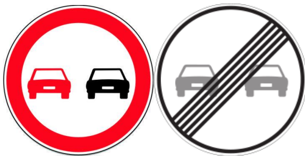
Figura 6.6: Señales de prohibición de adelantamiento y de fin de prohibición de adelantamiento
