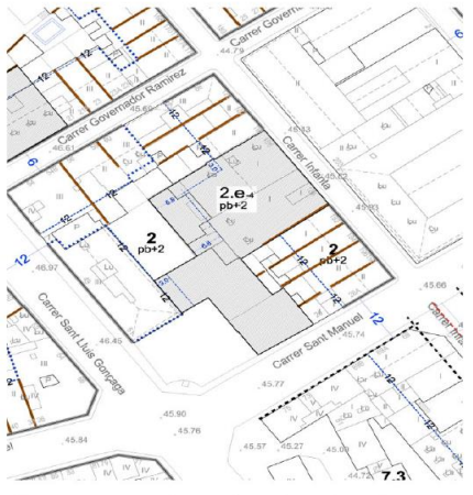
2e F. c. Infants, 186-189 - c. Sant Manuel Sò: 951 m 2 Sòlter: 951 m 2 Eficacitat útil nota: 1,0 Açada: pb+2
