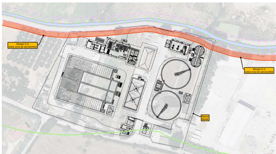
Figura 10. Zona de servitud del torrent d'Inca. Cap element de l'EDAR s'emplaça dins d'aquesta zona, a excepcions dels murs perimetrals.
