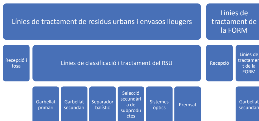
Figura 3-28. Esquema de l'àrea de pretractament de la Planta de Triatge de Residus i Tractament de la Matèria Orgànica.
