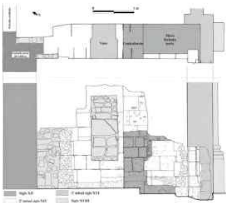
Capilla de Sant Antoni, muro este con la indicación de las fases constructivas. Al extremo la pilastra que oculta las anteriores góticas.
