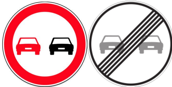
Figura 6.6: Señales de prohibición de adelantamiento y de fin de prohibición de adelantamiento
