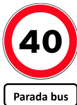
Figura 6.4: Señal de limitación de velocidad a 40 km/h con panel complementario con la inscripción "parada bus"
